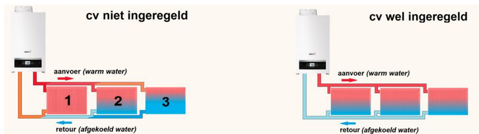
Afbeelding 3: principe waterzijdig inregelen
